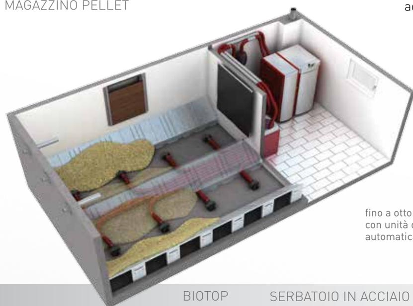
L'utilizzo del serbatoio in acciaio o del serbatoio in tessuto può essere una possibile alternativa a un magazzino per il pellet in muratura per il consumo di pellet fino a dieci tonnellate.
