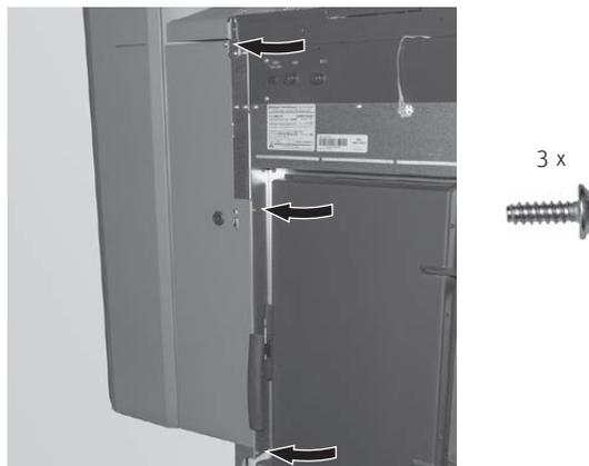
Fig. 61 Avvitare il rivestimento anteriore
