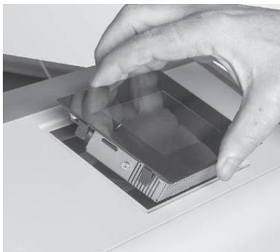
Fig. 72 Inserire InfoWIN Touch nel pannello di comando
