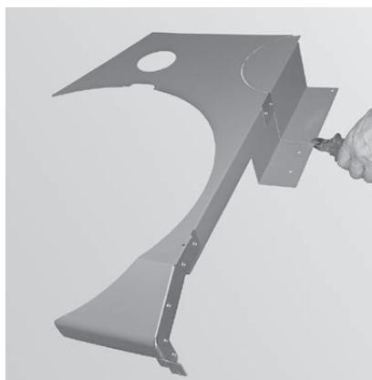
Fig. 57 Staccare la prepunzonatura solo se il raccordo gas combusti è rivolto verso l'alto
