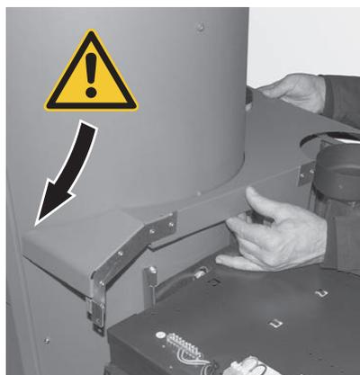
Fig. 58 Posare il rivestimento sinistro superiore con cautela
