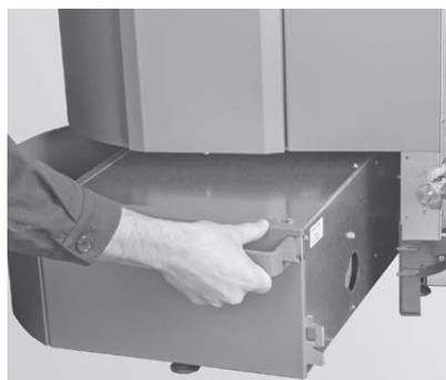
Fig. 77 Inserire il cassetto raccogli cenere spingendolo leggermente inclinato e introdurre completamente la maniglia nel cassetto
