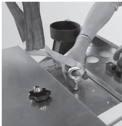
Fig. 16 Montaggio dell'occhiello (non compreso nella fornitura) per il gancio gru
