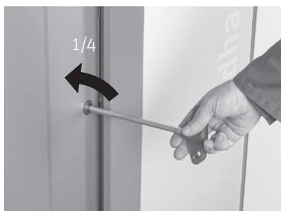
Fig. 94 Aprire la porta di contenimento con la chiave a brugola
