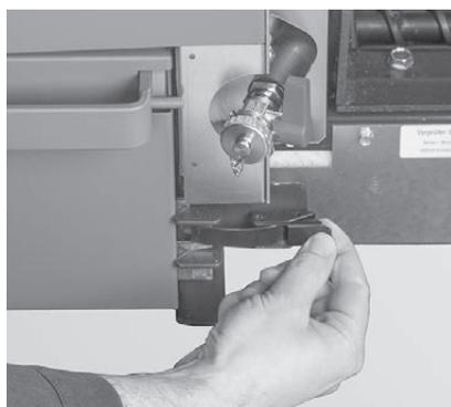
Fig. 78 Chiudere la chiusura a staffa di fissaggio
