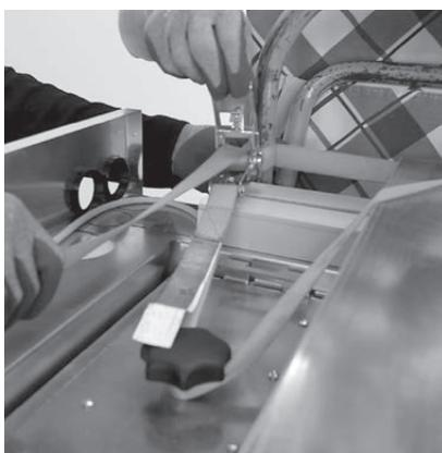
Fig. 14 Fissare la caldaia alla slitta con la cinghia elastica
