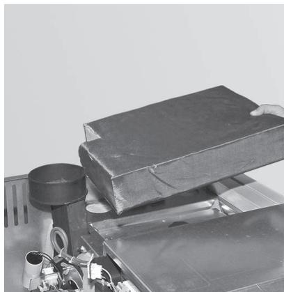
Fig. 28 Rimuovere l'isolamento
