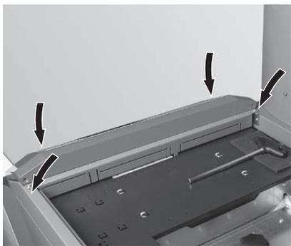
Fig. 96 Allentare le 4 viti del pannello di comando
