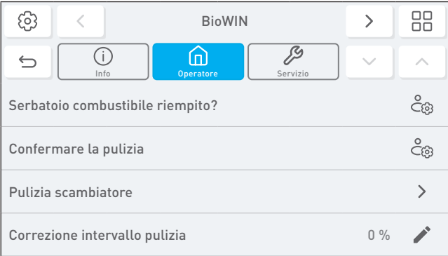
Fig. 91 Settore utente di caldaia a pellet, Visualizzazione con serbatoio giornaliero o settimanale
