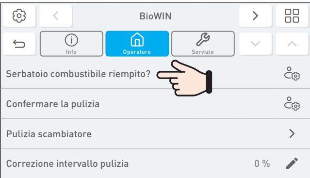
Fig. 92 Settore utente di caldaia a pellet, Visualizzazione con serbatoio giornaliero o settimanale
