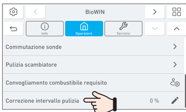
Fig.118 Settore utente di caldaia a pellet
