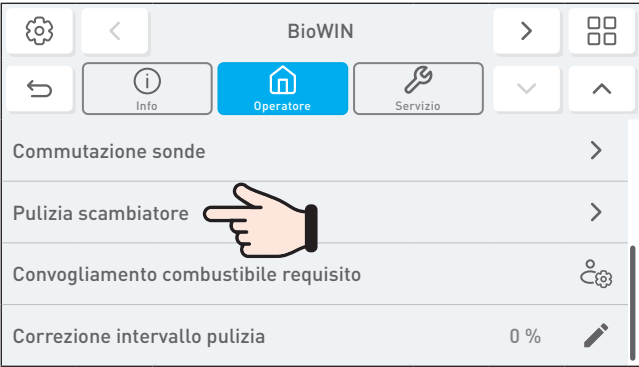
Fig. 112 Settore utente di caldaia a pellet
