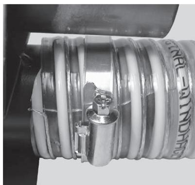
Fig. 24 Montaggio delle cravatte fermatubi
