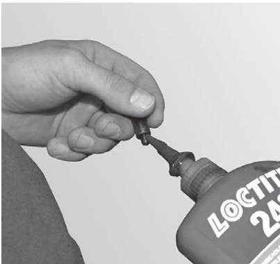
Fig. 33 Versare del liquido per bloccaggio viti sulla vite di spallamento
