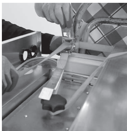
Fig. 16 Fissare la caldaia alla slitta con la cinghia elastica
