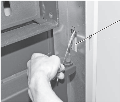
Fig. 68 Passare la sonda Thermocontrol 1.....Prepunzonatura – passaggio
