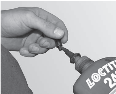
Fig. 37 Flüssige Schraubensicherung auf Ansatzschraube geben
