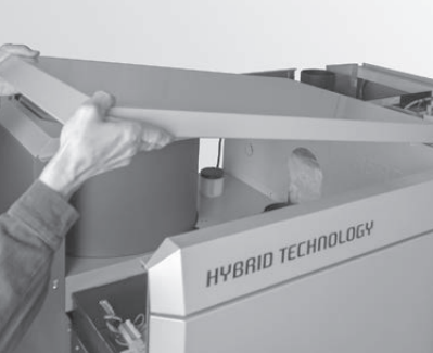
Fig.138 Applicare il coperchio lato caldaia a pellet e spingerlo verso la parte posteriore
