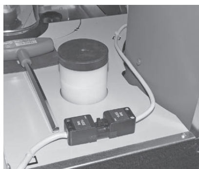
Fig. 170 Montare la presa di rete dietro il bocchettone di riempimento
