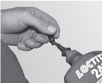
Fig. 43 Versare del liquido per bloccaggio viti sulla vite di spallamento
