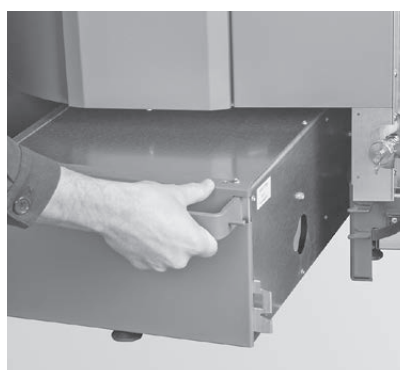
Fig. 146 Inserire il cassetto raccogli cenere spingendolo leggermente inclinato e introdurre completamente la maniglia nel cassetto
