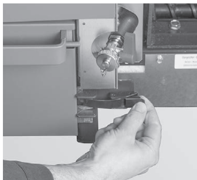
Fig. 147 Chiudere la chiusura a staffa di fissaggio
