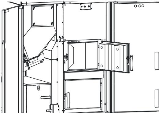
Fig. 37 Aprire la porta di contenimento e lo sportello della camera di combustione
