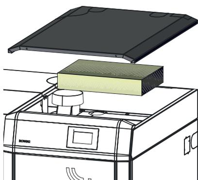
Fig. 47 Togliere il coperchio del rivestimento, rimuovere l'isolamento
