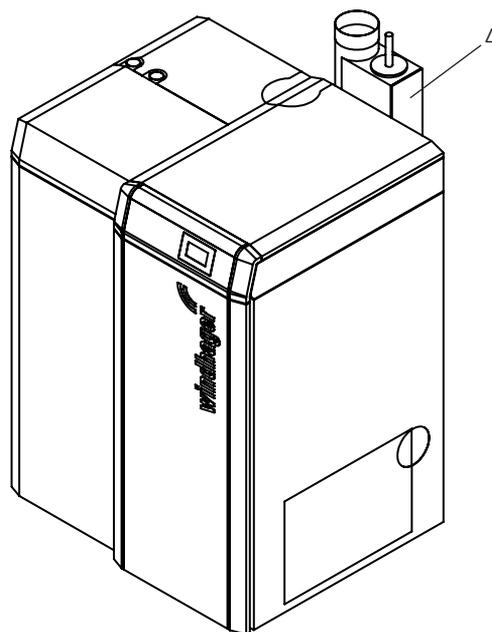
Fig. 53 Aperture di pulizia nel tubo dei gas combusti – vista da davanti, (schizzo senza isolamento del tubo dei gas combusti)
