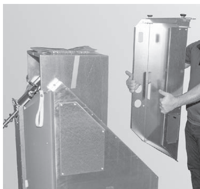
Fig. 33 Rimuovere il piede d'appoggio
