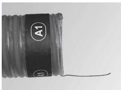
Fig. 18 Spellare il filo di terra, apporre l'etichetta adesiva
