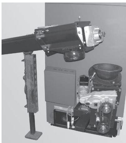
Fig. 163 Puntellare l'unità di trasferimento
