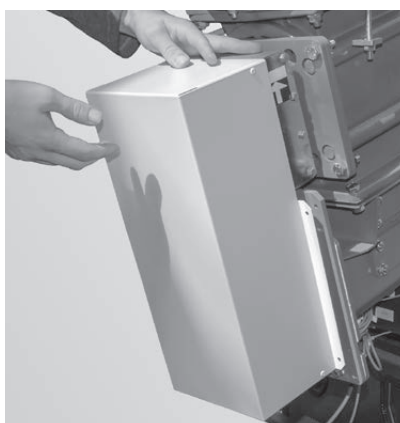
Fig. 119 Montare la copertura protettiva
