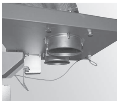
Fig. 211 Inserire le due spine – vista dal basso sul retro
