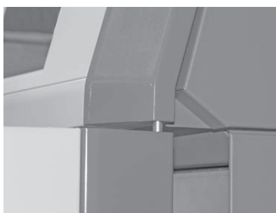
Fig. 86 Applicare il pannello di comando, agganciare la porta di contenimento al perno
