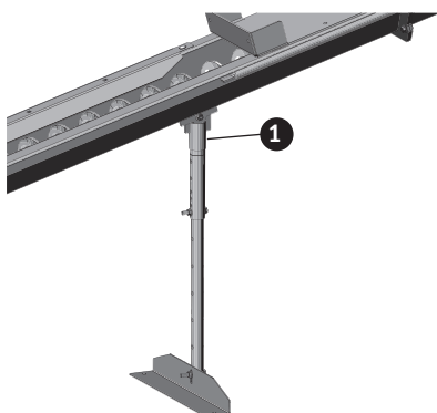
Fig. 169 Fissare il piede d'appoggio e avvitarlo saldamente al pavimento
