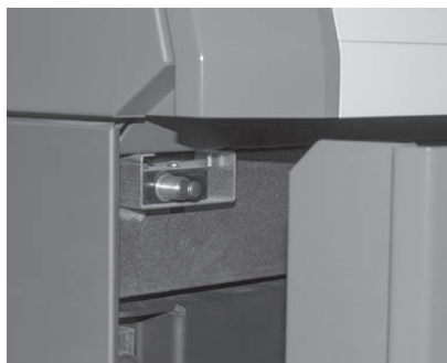
Fig. 88 Impostare l'interruttore di sicurezza porta PuroWIN PW 24-60
