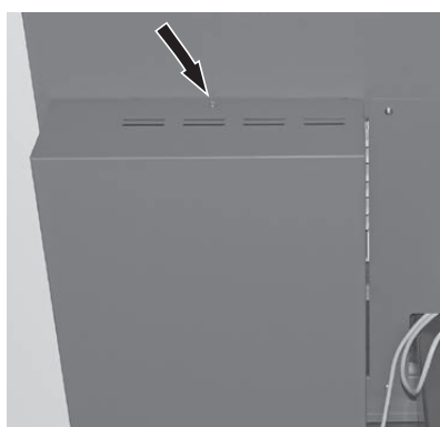
Fig. 253 Copertura sopra i convertitori di frequenza
