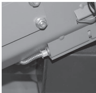
Fig. 235 Collegamento sonda per protezione dal ritorno di fiamma sulla coclea di dosaggio
