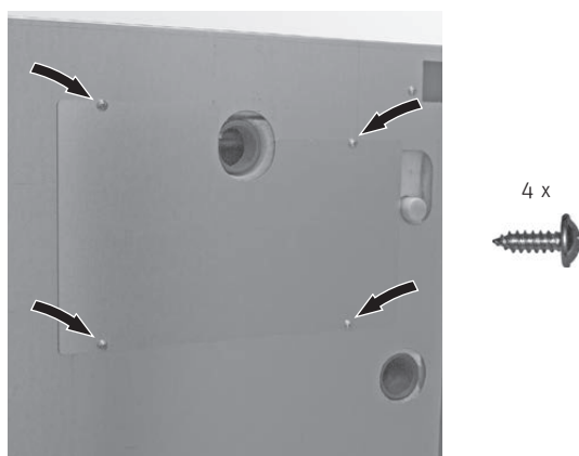
Fig. 69 Montare la copertura in corrispondenza della tiranteria per la pulizia
