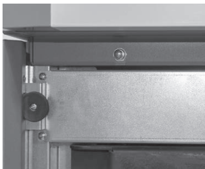
Fig. 89 Impostare l'interruttore di sicurezza porta PuroWIN PW 72-103
