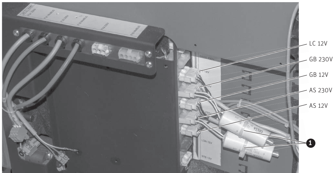
Fig. 37 Inserire 3 interruttori di prossimità e 2 motori
