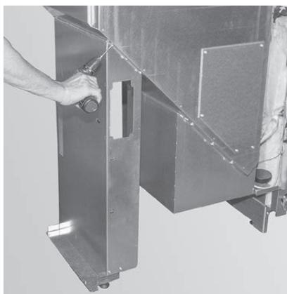
Fig. 60 Fissare il piede d'appoggio con 3 viti su ciascun lato
