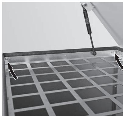
Fig. 85 Avvitare saldamente la parete laterale a sinistra in alto all'interno del serbatoio settimanale con 2 viti
