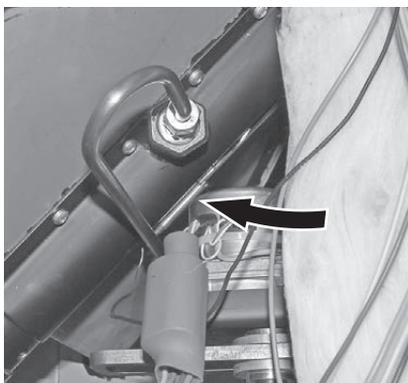
Fig. 50 Introdurre completamente la sonda per il termostato di sicurezza del tubo della coclea
