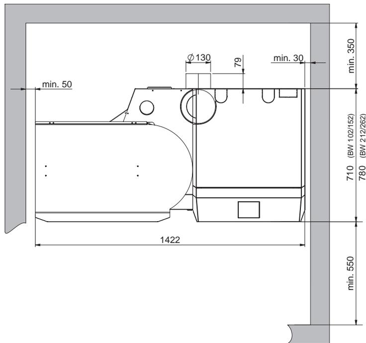
Fig. 30 BioWIN lite tubo dei gas combusti in alto - vista dall'alto
