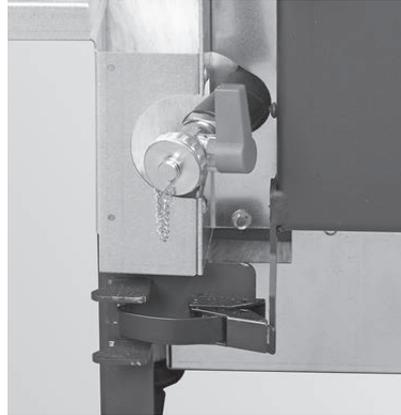
Fig. 33 Avvitare il rubinetto di riempimento e svuotamento (posizione della maniglia a destra) e reinserire la maniglia
