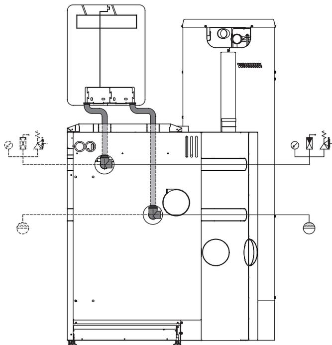
Fig. 26 Opzioni di collegamento dell'adattatore idraulico ripartitore 3/4" – vista dal retro senza parete posteriore
