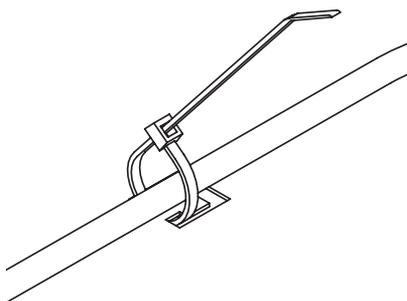
Fig.130 Fissare i cavi con una fascetta per cavi come scarico della trazione
