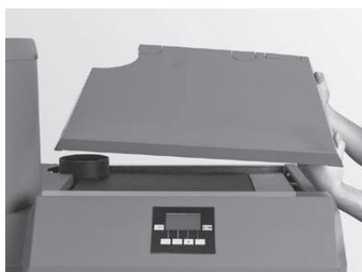
Fig. 118 Rimuovere il coperchio del rivestimento
