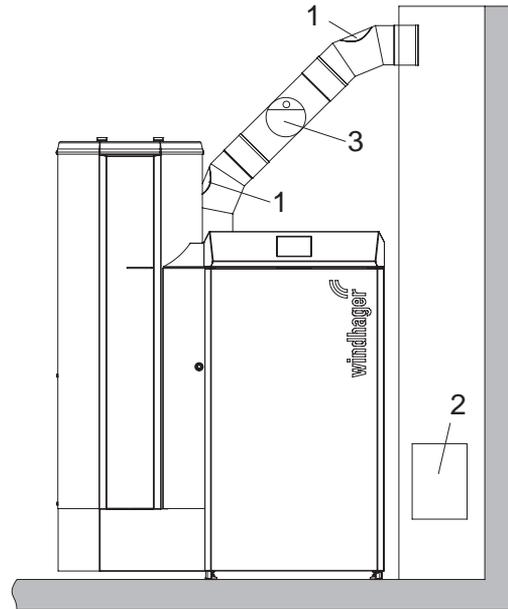
Fig. 113 Raccordo gas combustivi verso l'alto - vista da davanti, (schizzo senza isolamento del tubo dei gas combustivi)
