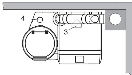
Fig. 115 Raccordo gas combustivi verso l'alto - vista dall'alto, (schizzo senza isolamento del tubo dei gas combustivi)
