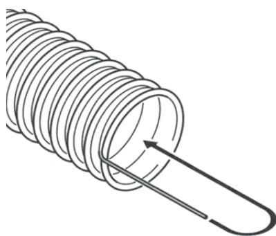
Fig. 107 Denudare il cavo di massa e piegarlo verso l'interno
