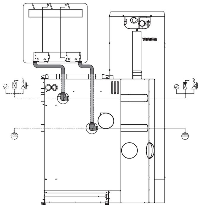
Fig. 27 Opzioni di collegamento dell'adattatore idraulico ripartitore 3/4" – vista dal retro senza parete posteriore
