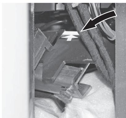
Fig. 45 Avvitare saldamente le viti di fissaggio in alto fino alla battuta (marcatura)
