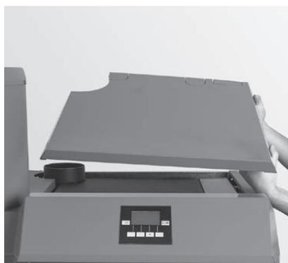
Fig. 135 Applicare il coperchio del rivestimento
