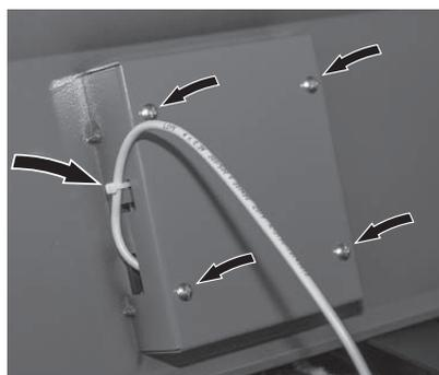
Fig. 100 Fissare InfoWIN<sup>PLUS</sup> con 4 viti e fissare i cavi di collegamento con una fascetta
