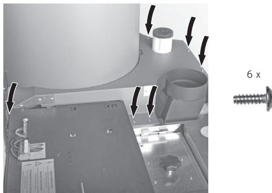
Fig. 80 Fissare il rivestimento con 6 viti autofilettanti
