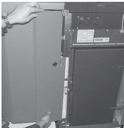
Fig. 70 Infilare il rivestimento anteriore
