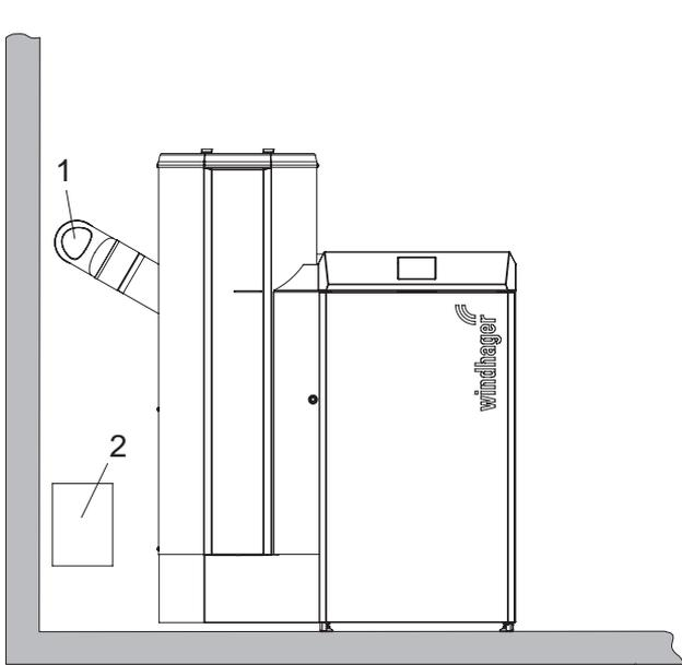
Fig. 112 Raccordo gas combustivi verso il retro - vista da davanti, (schizzo senza isolamento del tubo dei gas combustivi)
