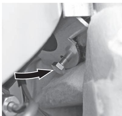
Fig. 46 Avvitare saldamente la stiva in basso con la vite M8 x 25
