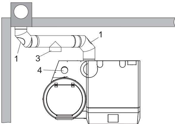
Fig. 114 Raccordo gas combustivi verso il retro - vista dall'alto, (schizzo senza isolamento del tubo dei gas combustivi)
