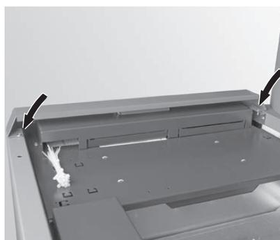
Fig. 102 Avvitare il pannello di comando con 2 viti autofilettanti
