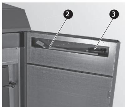
Fig. 111 Pennello per la pulizia e spatola all'interno della porta di contenimento (opzionale)
