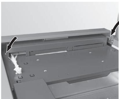
Fig. 122 Allentare le 2 viti del pannello di comando
