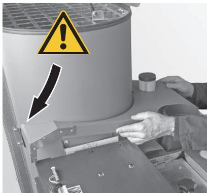
Fig. 79 Posare il rivestimento sinistro superiore con cautela
