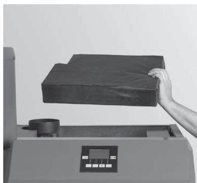
Fig. 134 Applicare l'isolamento
