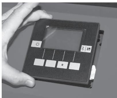
Fig. 99 inserire InfoWIN<sup>PLUS</sup> nel pannello di comando
