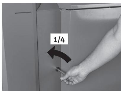
Fig. 120 Aprire la porta di contenimento con la chiave a brugola
