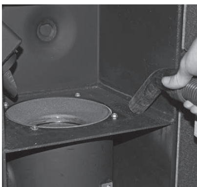
Fig. 46 Rimuovere i residui di combustione dalla camera di combustione
