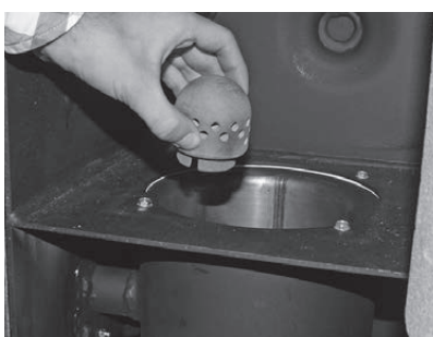
Fig. 52 Estrarre la spina aria primaria
