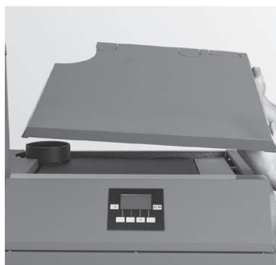
Fig. 70 Togliere la copertura in alto
