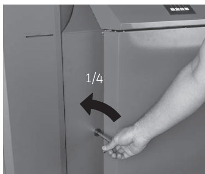
Fig. 5 Aprire la porta di contenimento con la chiave a brugola
