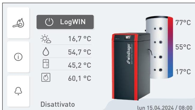
Fig. 62 La caldaia è spenta (ad es. LogWIN 2 DELUXE)
