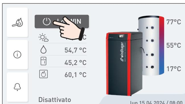
Fig. 63 Accensione caldaia caldaia (ad es. LogWIN 2 DELUXE)
