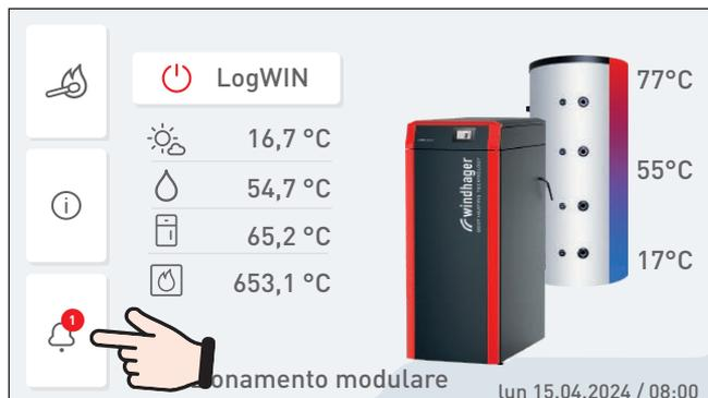
Fig. 78 Schermata di partenza caldaia (ad es. LogWIN2 DELUXE)
