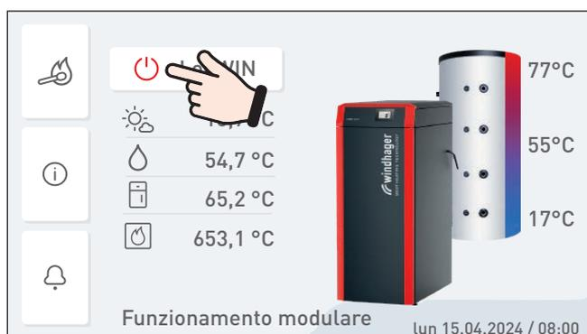
Fig. 58 Schermata di partenza caldaia (ad es. LogWIN 2 DELUXE)
