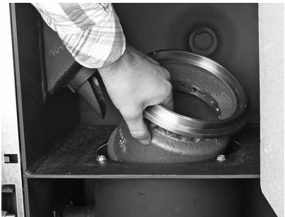
Fig. 52 Estrarre il cono parte inferiore
