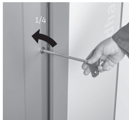
Fig. 5 Aprire la porta di contenimento con la chiave a brugola
