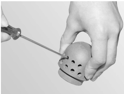
Fig. 57 Pulire con cautela la spina aria primaria
