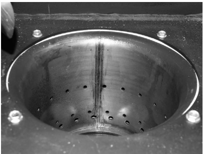
Fig. 58 Pulire i fori dell'aria secondaria nel corpo caldaia
