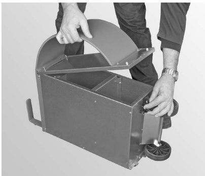
Fig. 46 Aprire le chiusure a staffa di fissaggio, rimuovere il coperchio e svuotare il contenitore cenere
