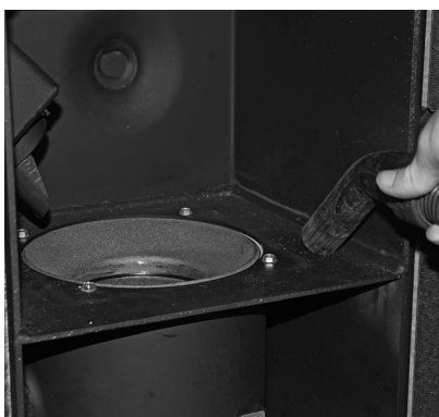
Fig. 50 Rimuovere i residui di combustione dalla camera di combustione
