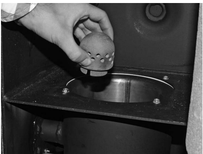
Fig. 56 Estrarre la spina aria primaria
