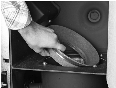
Fig. 51 Estrarre il cono parte superiore
