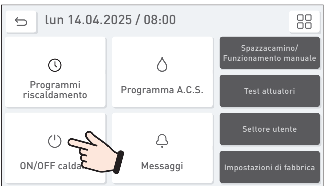
Fig. 4 Spegnere caldaia a pellet
