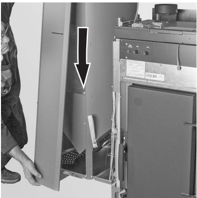
Fig. 82 Spingere la mascherina in basso e rimuoverla (chiusura a baionetta)
