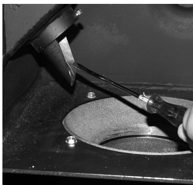
Fig. 49 Pulire il tubo di caduta
