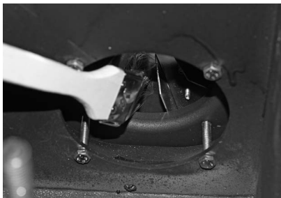
Fig. 70 Pulire e aspirare il ventilatore
