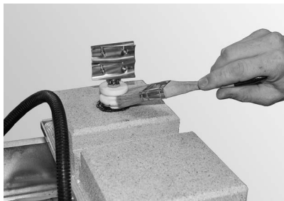
Fig. 71 Pulire l'elettrodo (solo per caldaie a pellet con collettore di polveri elettrostatico)
