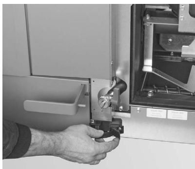
Fig. 43 Aprire la chiusura a staffa di fissaggio
