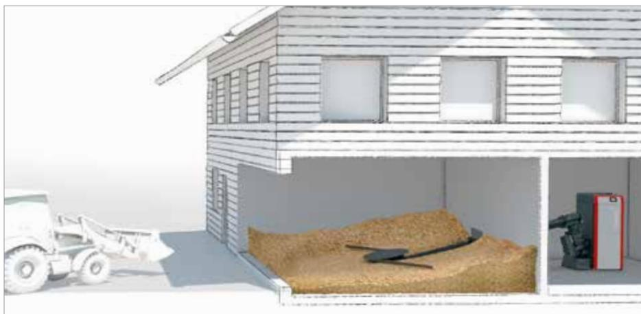
**02. Caldaia nel seminterrato e magazzino al pianterreno:**
