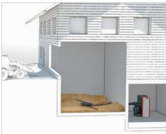
**04. Caldaia e magazzino nel seminterrato – variante 1:**
