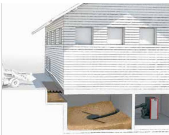
**05. Caldaia e magazzino nel seminterrato – variante 2:**
