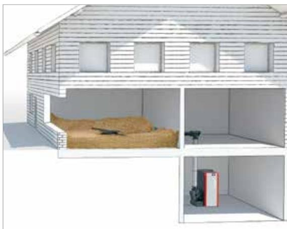
**03. Caldaia nel seminterrato, magazzino nel mezzanino:**
